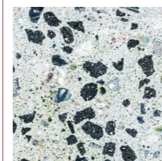
vana hoone silikaattellise taaskasutamine betooni täitematerjalina
